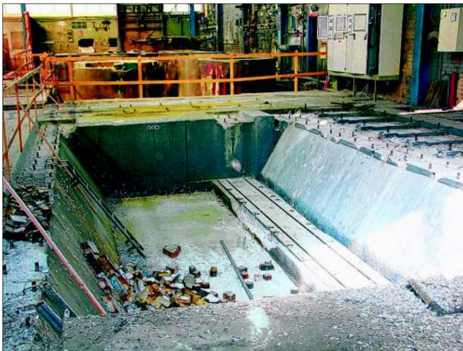
In den Tauchbecken sind früher Bleche vor allem für die Automobilindustrie verchromt worden. Die dabei freigesetzten Schadstoffe belasten den Untergrund bis heute. Fotos: Bernd Zeyer
