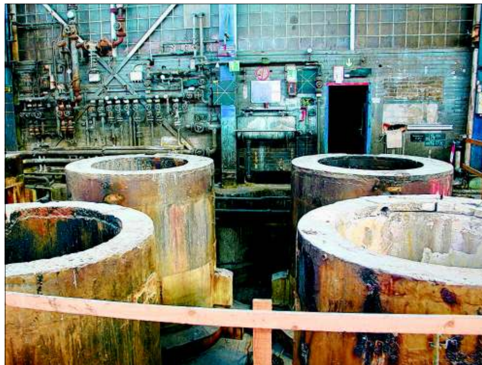
In den Tauchbecken sind früher Bleche vor allem für die Automobilindustrie verchromt worden. Die dabei freigesetzten Schadstoffe belasten den Untergrund bis heute. Fotos: Bernd Zeyer
