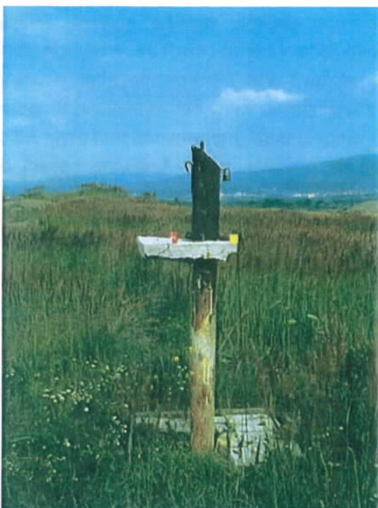
Obrázek 6.4.5 – sednutí terénu v místě vrtu LCH90 (Lochočická výsypka – Lom Chabařovice)
